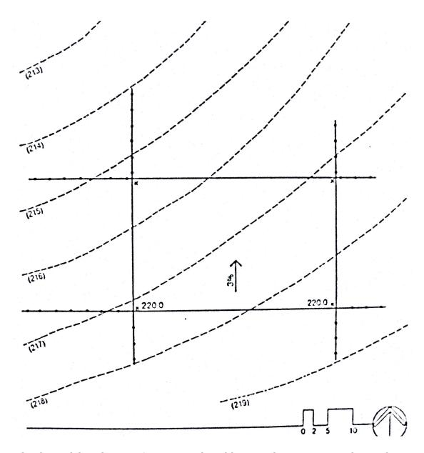
Sebuah tapak berukuran 25 m x 40 m akan dibangun dengan menetapkan titik elevasi di bagian selatan setinggi 220.0 (perhatikan gambar). Untuk tujuan drainase, tapak dimiringkan 3% ke arah utara.
